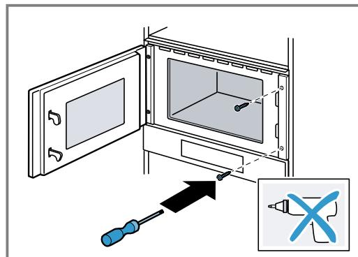
5. Predvŕtajte otvory pre skrutkové spojenie na nábytku na strane závesov.
