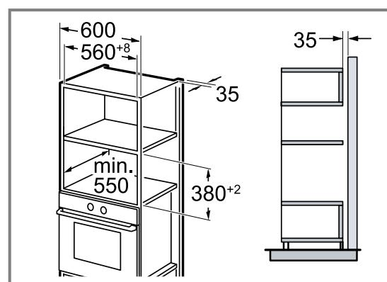
Urządzenie należy zamontować na takiej wysokości, aby możliwe było swobodne wyjmowanie wyposażenia. Wyregulować nóżki.
