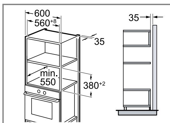
Montați aparatul la o înălțime corespunzătoare, astfel încât să puteți scoate cu ușurință accesoriiile. Reglați picioarele de sprijin.
