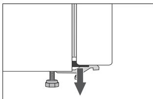
Rohy dveří jsou opatřeny distančními vložkami. Odstraňte je a zasuňte do jejich drážek čepy, které jsou součástí dodávky (pouze u některých modelů).
