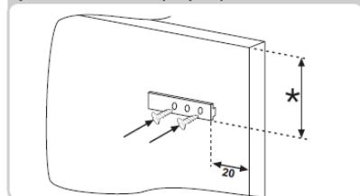
Otworzyć drzwi szafki i lodówki. Włożyć wbudowaną wkładkę do ślimaczka, a następnie przyłożyć do drzwi lodówki.
