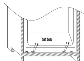
Plaats de afschuiving op de kast, snijd het overschot indien nodig eraf. Plaats de onderste delen met de plastic afdekkingen.
