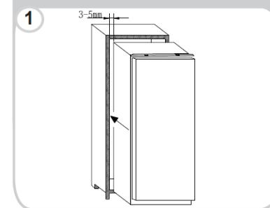
Após se assegurar da correspondência entre a porta do aparelho e a porta da coluna, aparafuse a parte superior do aparelho ao armário.
