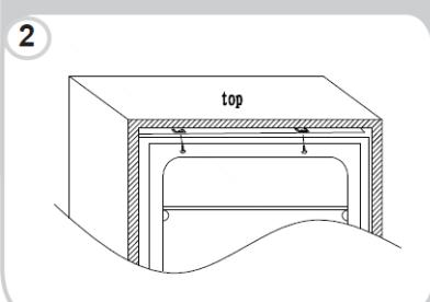
Ajuster le joint d'étanchéité de l'appareil, si nécessaire, découper la surlongueur. Fixer les pièces inférieures avec les caches plastiques.
