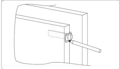
Die Gerätetür mit der Korpusfront verbinden und die Schlitze des Mitnehmers zur Ausrichtung verwenden.
