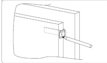
Collegare lo sportello dell'elettrodomestico ai pannelli del vano utilizzando le scanalature della slitta come guida.
