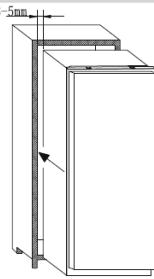
Verbind de apparaatdeur met het kastpaneel en gebruik de ladersleuven als richtlijn.
