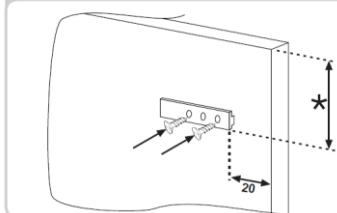
Abra as portas da coluna embutida e do frigorífico. Posicione o carregador embutido na corrediça e encaixe na porta do frigorífico.
