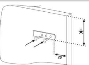
Open de deuren van de inbouwkast en de koelkast. Plaats de inbouwlader in de slede en pas in de koelkastdeur.
