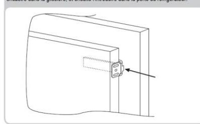
Marquer les points de fixation des vis et percer avec un foret de 2,5 mm de diamètre.
