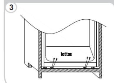
Umistěte těsnění spotřebiče, v případě potřeby uřízněte přečnívající část. Na spodní část nasadte plastové kryty.
