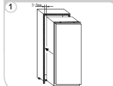
Zkontrolujte zarovnání dveří spotřebiče a skříně a poté přišroubujte horní část spotřebiče ke skříně.
