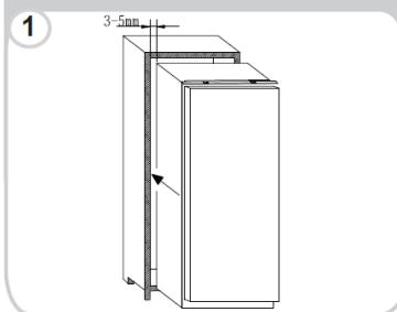
Accertarsi che lo sportello dell'elettrodomestico sia allineato all'altezza dell'incasso e avvitare la parte superiore dell'elettrodomestico al vano.
