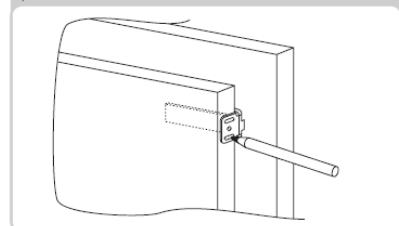
Połączyć drzwi urządzenia z panelem szafki, wykorzystując szczelinę wkładki jako prowadnice.
