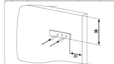
Abra as portas da coluna embutida e do frigorífico. Posicione o carregador embutido na corrediça e encaixe na porta do frigorífico.
