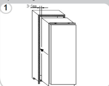
Po zapewnieniu pasowania między drzwiami urządzenia a drzwiami zabudowy meblowej, przykroić górną część urządzenia do szafki.
