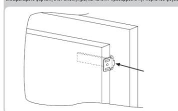
Σημειώστε τα σημεία στερέωσης για τις βίδες και ανοίξτε τρύπες με τρυπανί διαμέτρου 2,5 mm.
