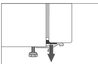
Rohy dveří jsou opatřeny distančními vložkami.
