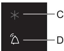
V případě nadměrného zvýšení teploty v zařízení zazní výstražný zvukový signál (přerušovaný tón) a symbol **D** začne blikat.
