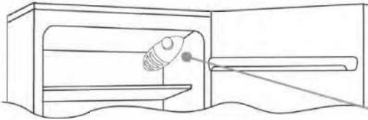
A caixa do termostato que controla o equipamento está localizada dentro do compartimento do frigorífico no lado superior direito. Para verificar se o equipamento está a funcionar, certifique-se de que o botão do termostato não está para "0".
