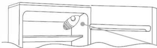
Die Thermostatbox zur Steuerung des Gerätes befindet sich oben rechts im Inneren des Kühlraums. Um zu prüfen, ob das Gerät in Betrieb ist, stellen Sie sicher, dass der Thermostatknopf nicht auf OE0 eingestellt ist.
