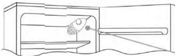
La scatola termostato per il controllo dell'apparecchio è collocata all'interno della cella frigo in alto a destra. Per essere certi che l'apparecchio stia funzionando controllare che la manopola di controllo del termostato non sia sulla posizione "0".
