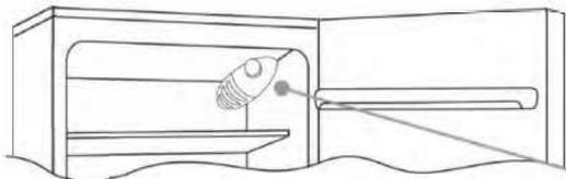
Termostat určený k ovladání spotřebiče je umístěn uvnitř chladničky vpravo nahoře. Pokud chcete zkontrolovat, že zařízení opravdu funguje, přesvědčete se, že termostat není nastaven v poloze „0“.
