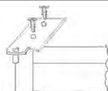
7 Αφαιρέστε την τάπα της αριστερής πλευράς και τοποθετήστε τη στη δεξιά πλευρά
