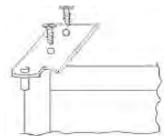
Entfernen Sie die Buchse von der linken Seite und versetzen Sie diese auf die rechte Seite.
