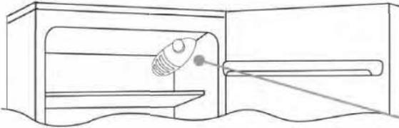
Το κουτί θερμοστάτη για τον έλεγχο της συσκευής βρίσκεται στο εσωτερικό του χώρου συντήρησης στο πάνω δεξιό μέρος. Για να ελέγξετε αν η συσκευή λειτουργεί, βεβαιωθείτε ότι το κουμπί του θερμοστάτη δεν έχει ρυθμιστεί στο „0“.
