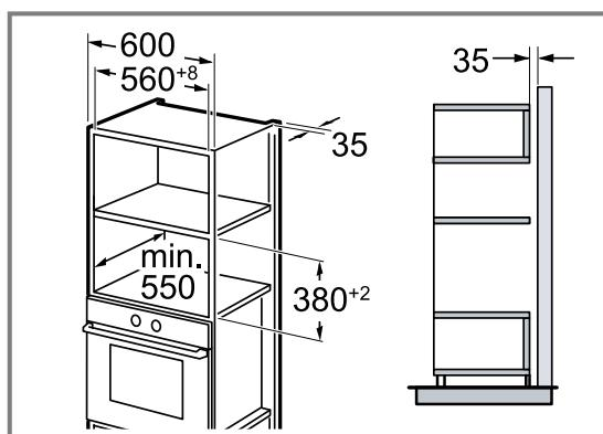
Urządzenie należy zamontować na takiej wysokości, aby możliwe było swobodne wyjmowanie wyposażenia.
