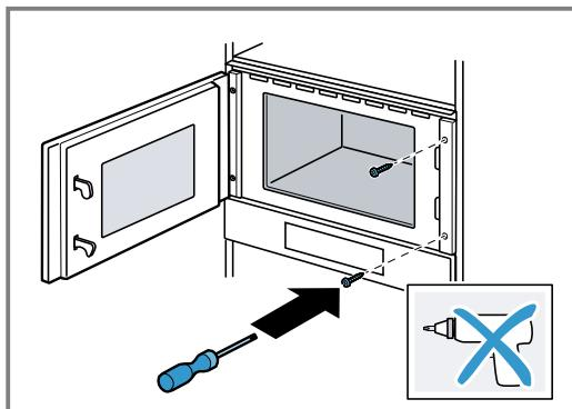
**5. Wywiercić otwory w celu wykonania połączenia śrubowego z boku zawiasów mebla.**
