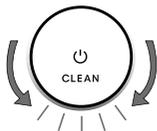
Atunci când robotul detectează că trebuie golit coșul colector, inelul luminos se va aprinde roșu semnalizând partea din spate.
