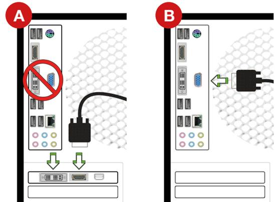
Počítač je vybaven různými typy grafických konektorů. Připojení monitoru proveďte opatrně s ohledem na konektor, kterým je vybaven. (Upozornění: některé aktuální modely grafických karet již nepodporují analogové VGA připojení, proto tímto konektorem nejsou vybaveny). V případě, že vlastním monitor či projektor pouze s analogovým VGA vstupem, doporučujeme výměnu za novější model s digitálním připojením.
