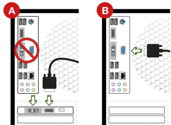
Počítač je vybavený rôznymi typmi grafických konektorov. Monitor pripojte opatrne, s ohľadom na konektor, ktorým je vybavený. (Upozornenie: niektoré aktuálne modely grafických kariet už nepodporujú analógové VGA pripojenie, preto nedisponujú týmto konektorom.) V prípade, že vlastníte monitor alebo projektor iba s analógovým VGA vstupom, odporúčame výmenu za aktuálnejší model s digitálnym pripojením.
